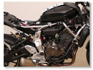
LOCATE THE ECU CONNECTOR BELOW THE FUEL TANK.
